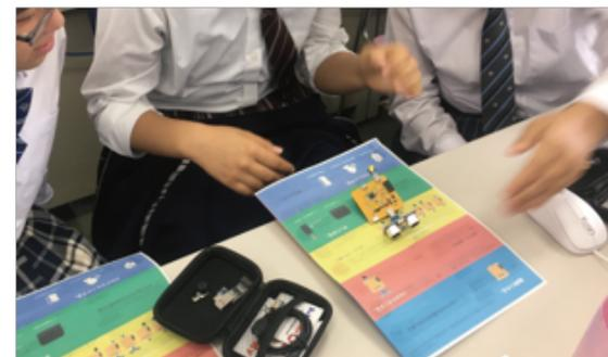
通常、センサーや、マイコンボードを扱うときは、電源タップやコンセントを必要とするのですが、電池で動くようにしてあるので、机の上が整頓された状態で行えるようにした。
